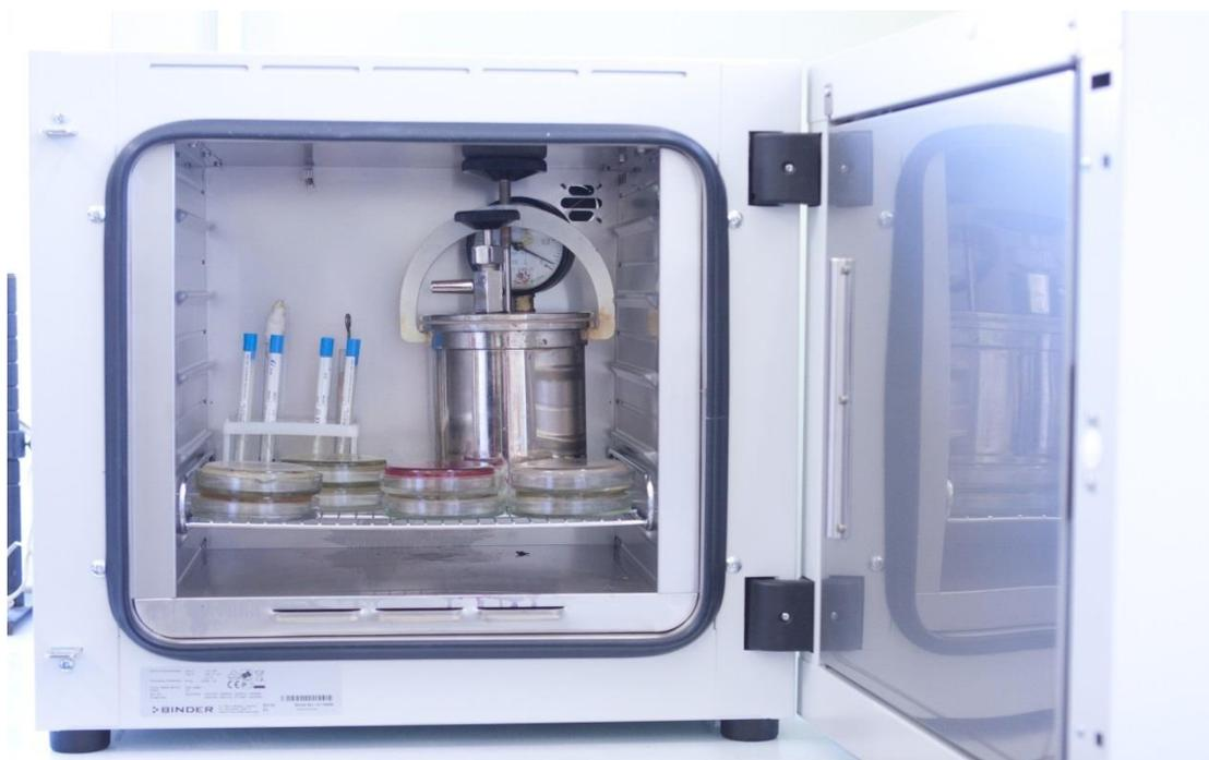
Рисунок 2.10 Микроанаэростат МИ Модель 752 (микробиологическая лаборатория РязГМУ)
