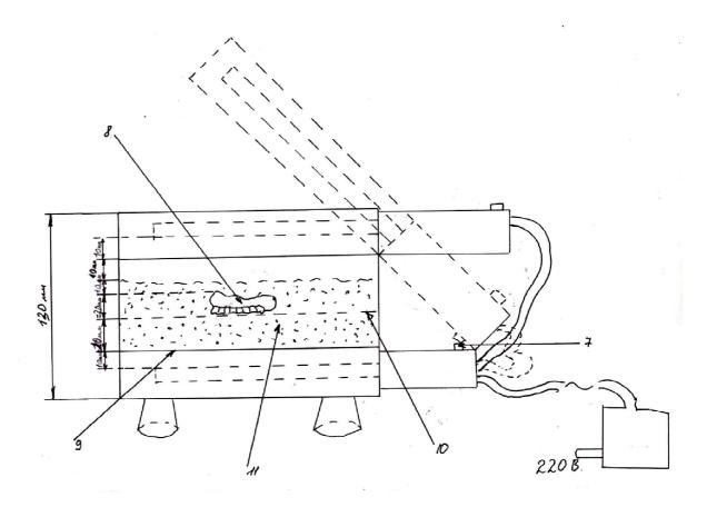
Рисунок 4.3.2 – Устройство на основе ультрафиолетового излучения. Вид сбоку (схема).
