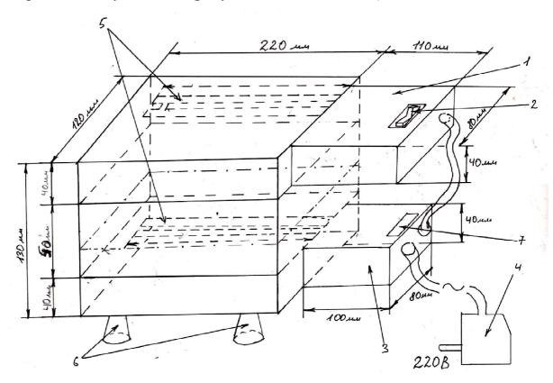
Рисунок 4.3.1 – Общий вид устройства на основе ультрафиолетового излучения (схема)
